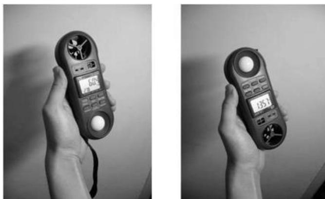
図7：マルチ環境測定器(左：温度・湿度・風速・風向測定時、右：照度測定時)
